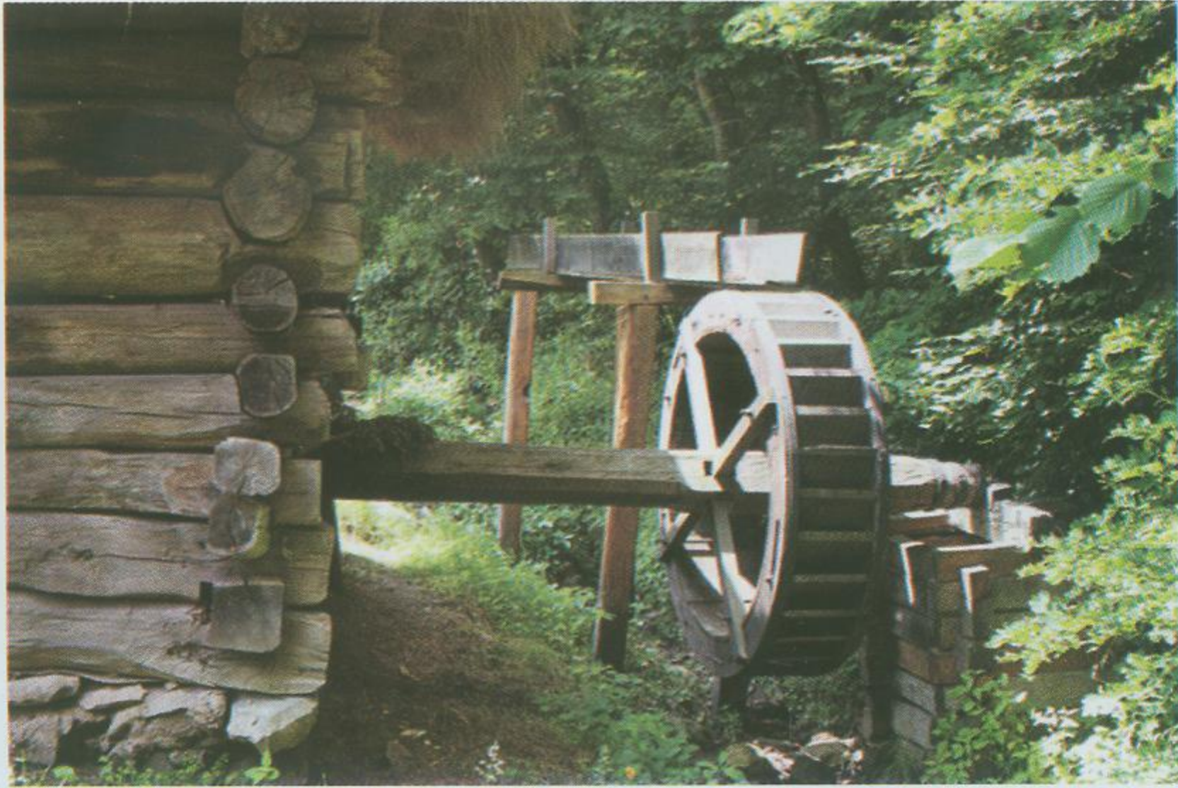
Instalația hidrolică a morii
