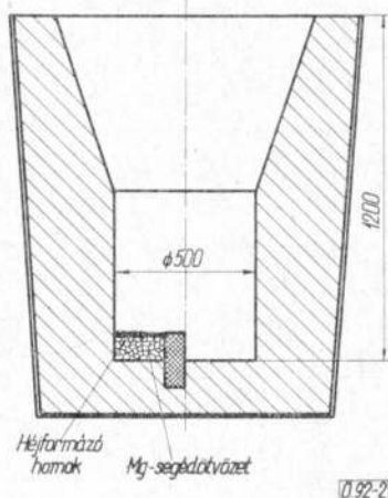
2. ábra. A ráöntéses eljáráshoz használt kezelőüst vázlata
