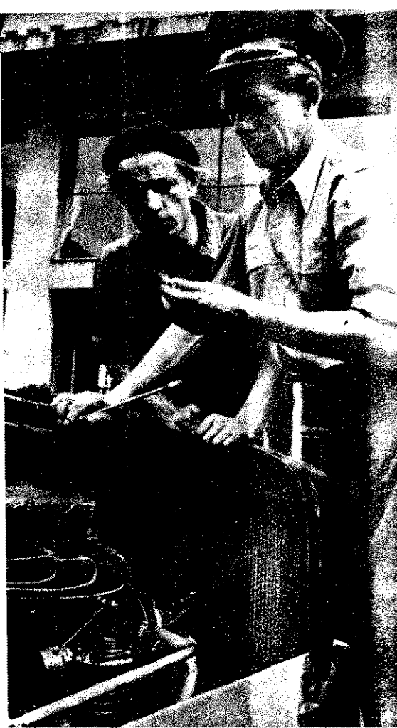
A motor felülvizsgálása során nem hagyhatjuk figyelmen kívül a gyertyák minőségét és a kompressziót, — ezeket műszerrel ellenőrizzük.
