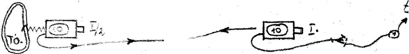
6. ábra. Tartályos gépjárműfecskendő és kismotorfecskendő egy időben való alkalmazásakor lehetőleg a nagyobb teljesítőképességű fecskendőt kell a vízforráshoz állítani
