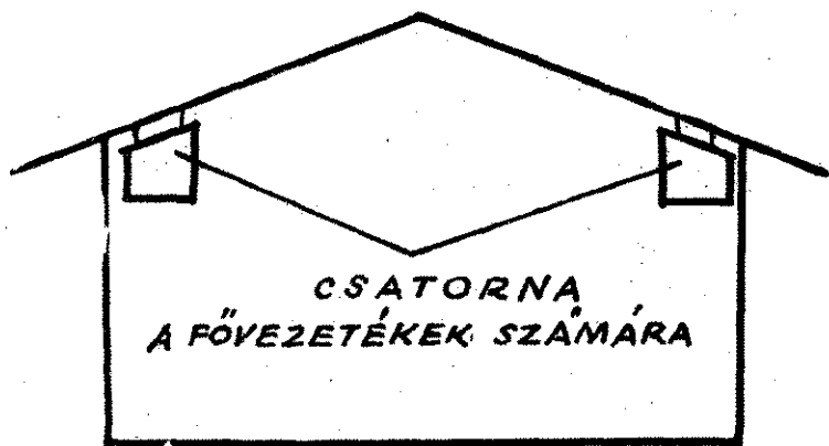
Csatorna beépítése a fővezetékek számára
