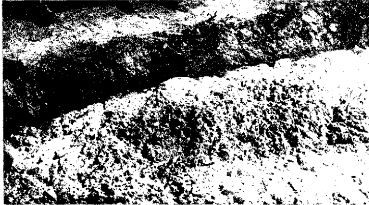
Jól záródott „kemény” habtakaró benzinfelületen, oltás után
