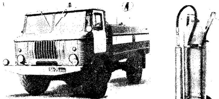
AC—30/66/184 típusú korszerűsített gépjárműfecskendővel
