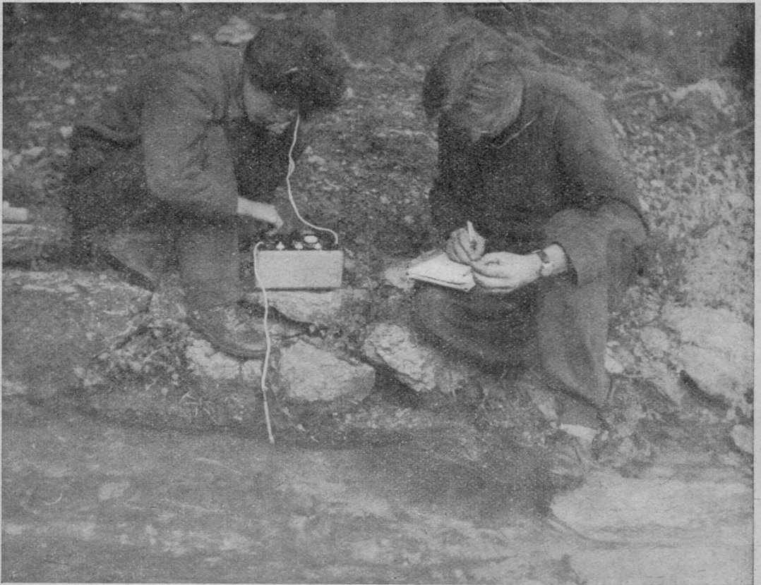
A forrásvíz elektromos ellenállásának mérése a Kecskékútnál (Szabadság barlang forrása) (Balázs Dénes felvétele)
