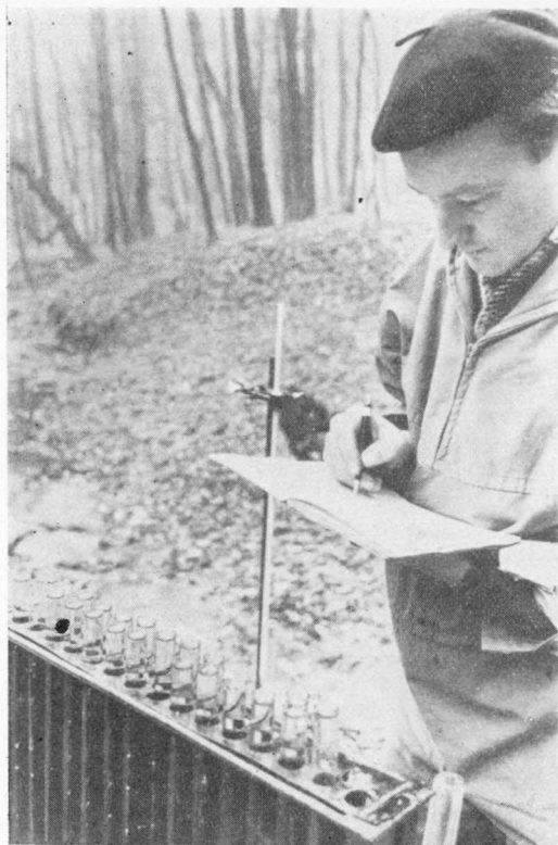
Kolorimetrláló kémcsövek használata terepen.
