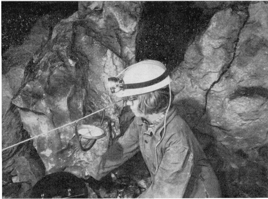
17. ábra. Függőkompass használata a barlangban. (Csekő A. felv.)
