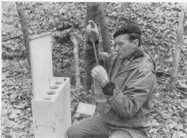
Terepen történő kolorimetrlálás kélliteres üveghengerekkel.
