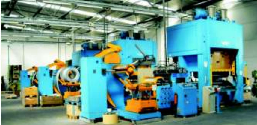
A három új 425 tonnás excenterprés
