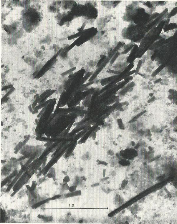
Abb. 2. Aggregate leistenförmig ausgebildeten Nontronits. Vergrößerung 26.000 ×.
