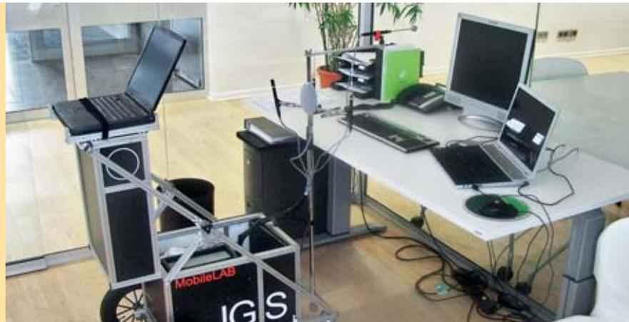
Abb. 8 Komfortmessung vor Ort mit Hilfe einer mobilen Messtechnik-Station. Gemessen werden u.a. Strahlungsasymmetrie, Lufttemperatur, Operative Temperatur, Taupunkttemperatur und Luftgeschwindigkeit. Foto: IGS
