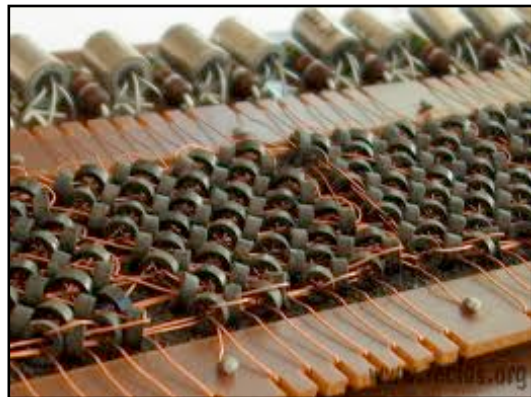
Figura 1. Núcleo de ferrita. Es la tecnología empleada para las memorias en los años 50, antes de que apareciesen los circuitos integrados
