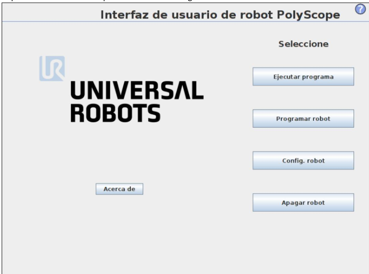
Figura 2.3: Pantalla de inicio de *Polyscope*
