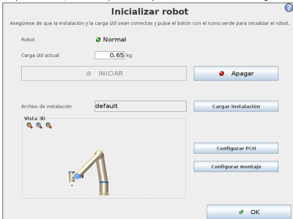
Figura 2.5: Pantalla de inicialización del robot en Polyscope
