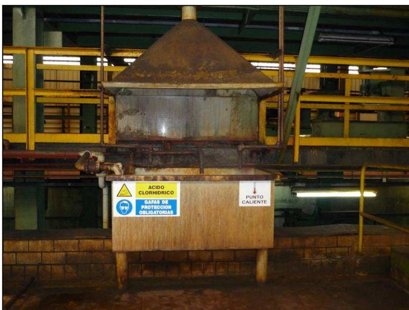
Fotografía 12: Pila de toma de muestras (Fuente: Elaboración propia)
