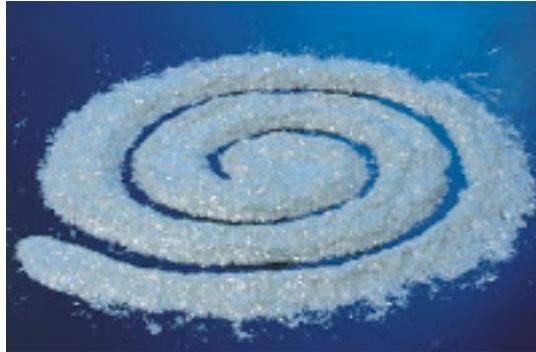
Fig. 45: Hilo cortado (Fibra corta)
