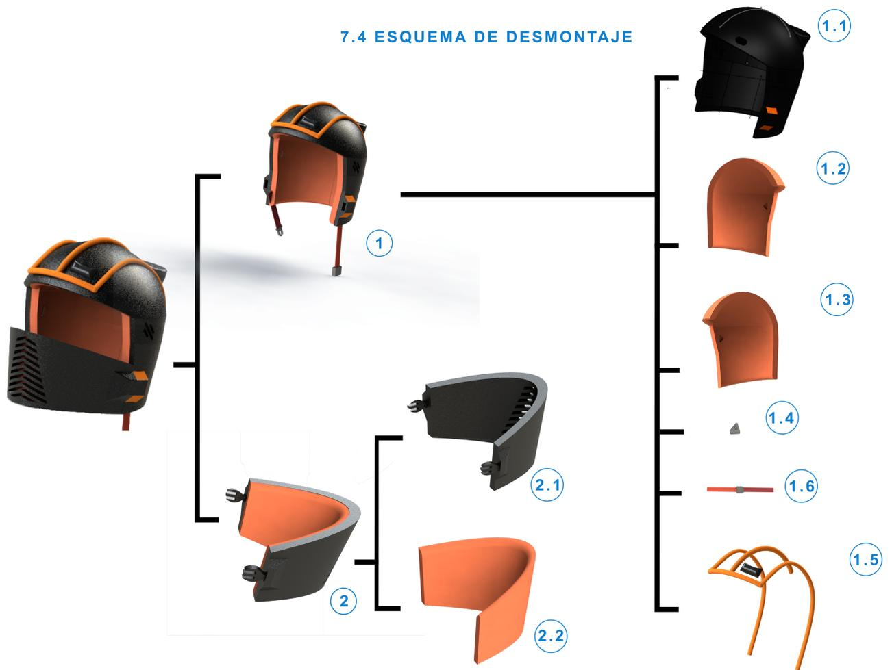
zFig. 33: Esquema de desmontaje del producto.
