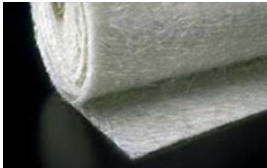
Fig. 48: Mat de filament continuo.
