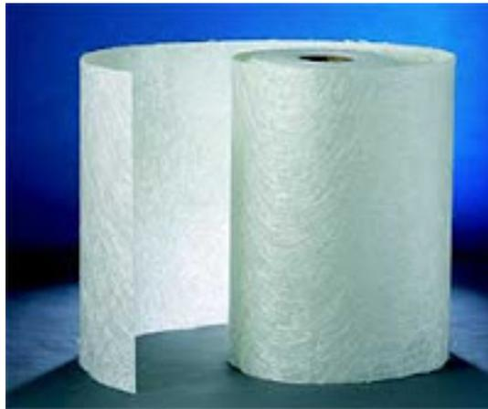
Fig. 47: Mat de hilos cortados.
