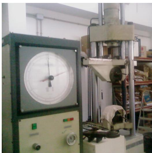
Se determinan resistencias a flexión y compresión a edades de 28 días  $\pm$  8 h curadas en cámara húmeda según condiciones expuestas en el apartado 3.3.3. Transcurridos los 28 días de curado se determinan las resistencias tras 7 días  $\pm$  2 h de envejecimiento acelerado según las condiciones del apartado 3.3.4. Previamente a la realización de los ensayos de las series envejecidas, se dejan enfriar una vez extraídas del baño termostático durante 1 hora a temperatura ambiente.
