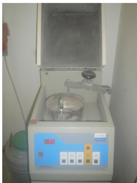
Se introducen 78 bolas de alúmina de 2 cm de diámetro y 400 g de ceniza volante, en un recipiente cerámico de 1 litro de capacidad. La duración del proceso de molienda se fija en 35 minutos para toda la ceniza volante empleada en este estudio. Una vez transcurrido el tiempo fijado se recoge la ceniza molida y se limpian las bolas y la jarra de los posibles restos con el fin de no mermar la eficacia de la molienda.
