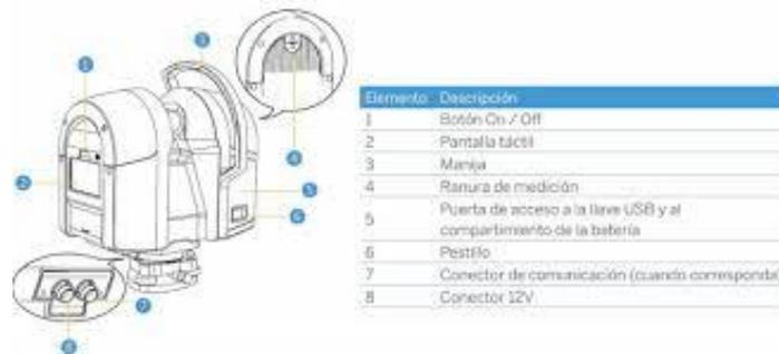
Figura 6: Elementos del menú del Trimble TX6
