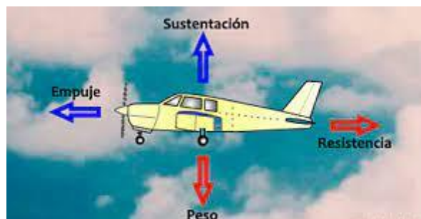
Ilustración 3. Fuerzas que actúan sobre una aeronave de ala fija en vuelo.
