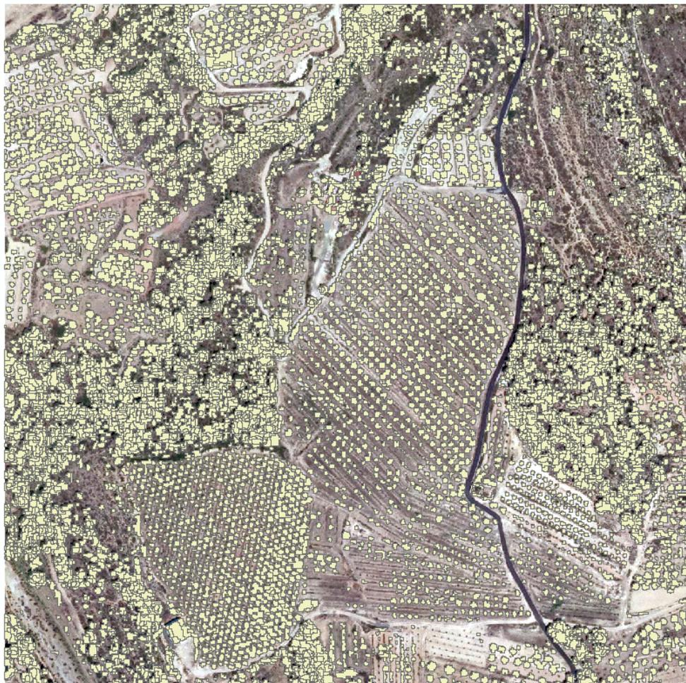
Fig. 176: Segmentación Zona Sur con  $sp=3$  y altura de copa  $> 1m$ .
