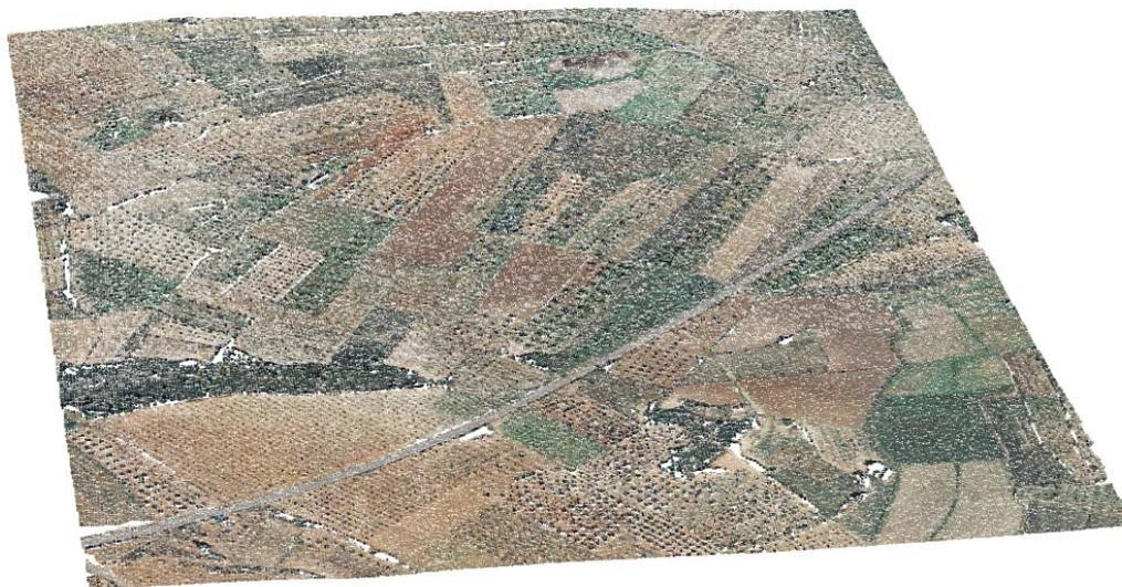
Fig. 65: Fichero de puntos *N\_MDT\_3.las* resultante del filtrado *GroundFilter*
