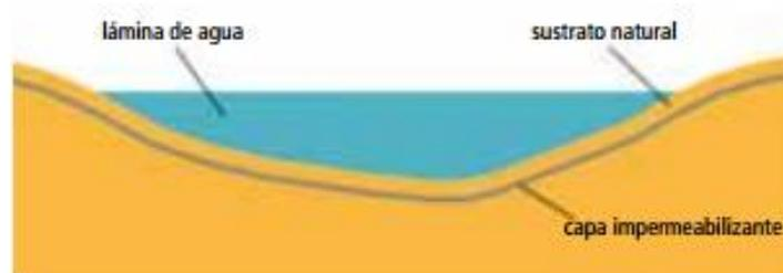
Figura 43- Esquema de colocación de la capa impermeabilizante.
