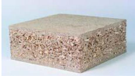
**Figure 15:** Sample of flax-board [www.bm-online.de](http://www.bm-online.de) , BM-Marktübersicht: Moderne Leichtbauwerkstoffe (2005)
