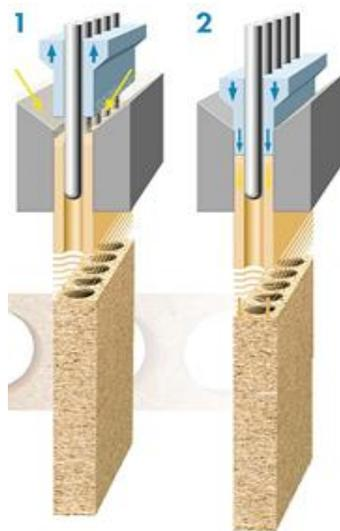
**Figure 12:** Warm extrusion press ([www.sauerland-spanplatte.de](http://www.sauerland-spanplatte.de))
