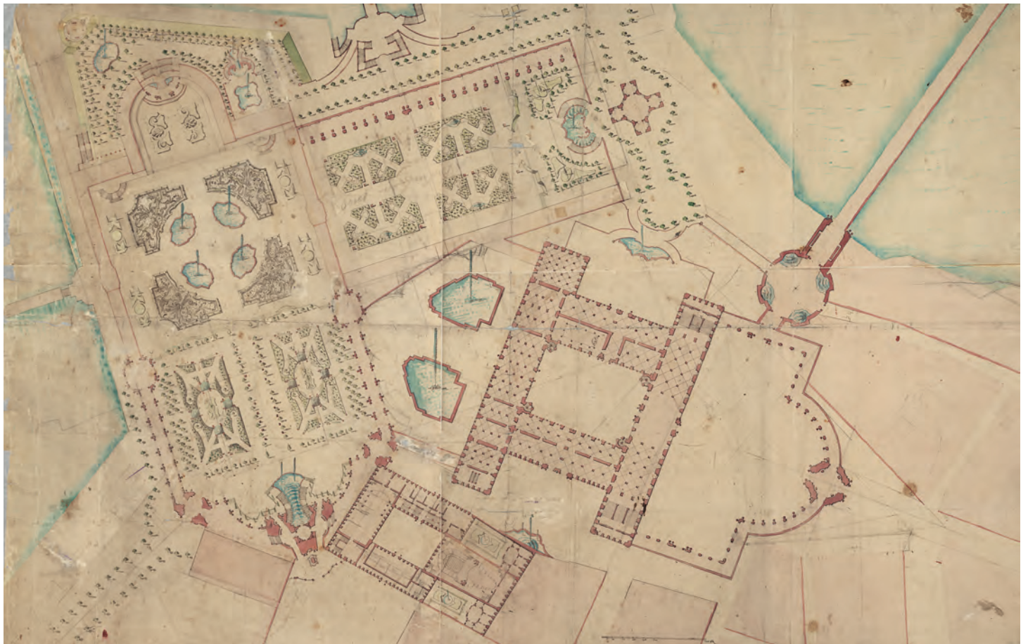
Abb. 4 M. D. Pöppelmann (eigenhändig?), Situationsplan zum Ausbau von Residenzschloss und Zwinger mit stadtseitigem Kaskadenturm-Parterre und elbseitiger Gartenanlage inklusive Lusthaus am Elbwall, farbig lavierte Federzeichnung, 84 × 123 cm, Maßstab zu 100 Ellen = 12,5 cm.
