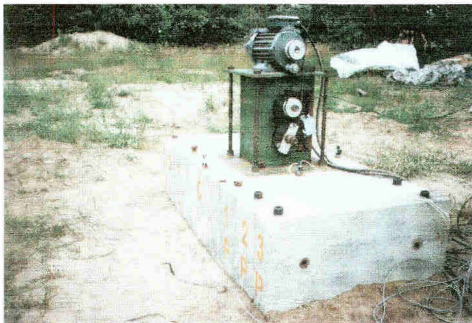
Rys. 3.9. Blok fundamentowy o wymiarach L \times B \times H = 1,6 \times 0,8 \times 0,7 m, zagłębienie h_p = 0,35 m
