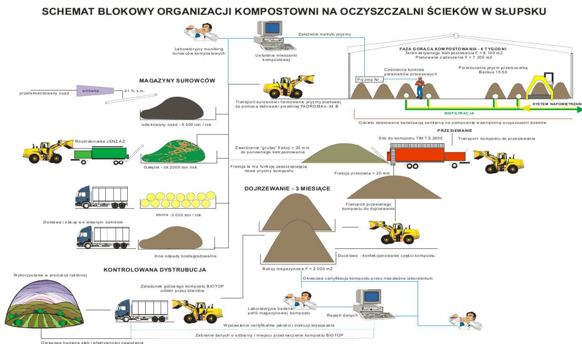
Rys. 3. Schemat technologii kompostowania na terenie Oczyszczalni Ścieków „Wodociągi Słupsk” w Słupsku (OS, etap III, bp1), źródło:
