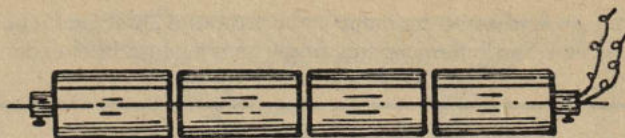
Reihenladung aus Sprengpatronen A (Boden an Boden)
