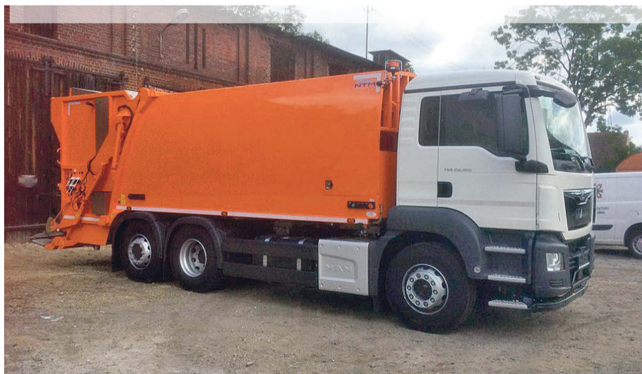
Do odbioru odpadów spółka kupiła specjalistyczny samochód, wyposażony w dwie komory, przeznaczony także do odbioru śmieci segregowanych
