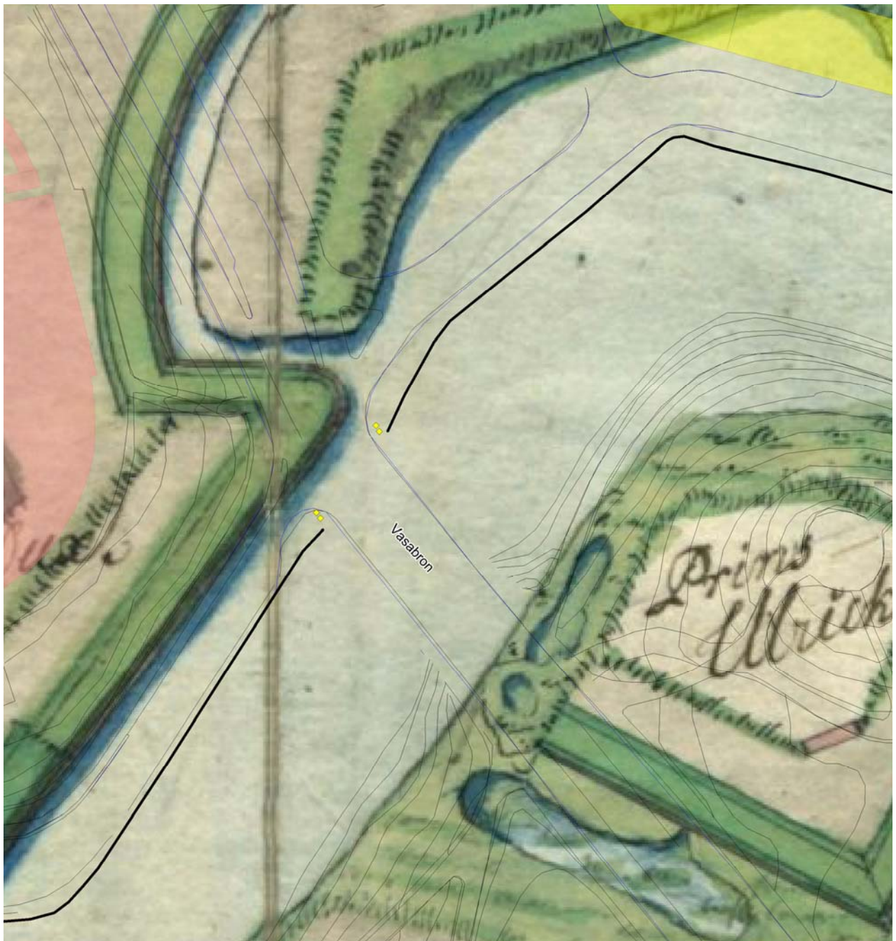
Figur 2. Borrhål i Vasabrons norr brofästa på rektifierad karta från 1795. Här antyds det att bastionsmuren ligger bakom den yngre kajmuren.
