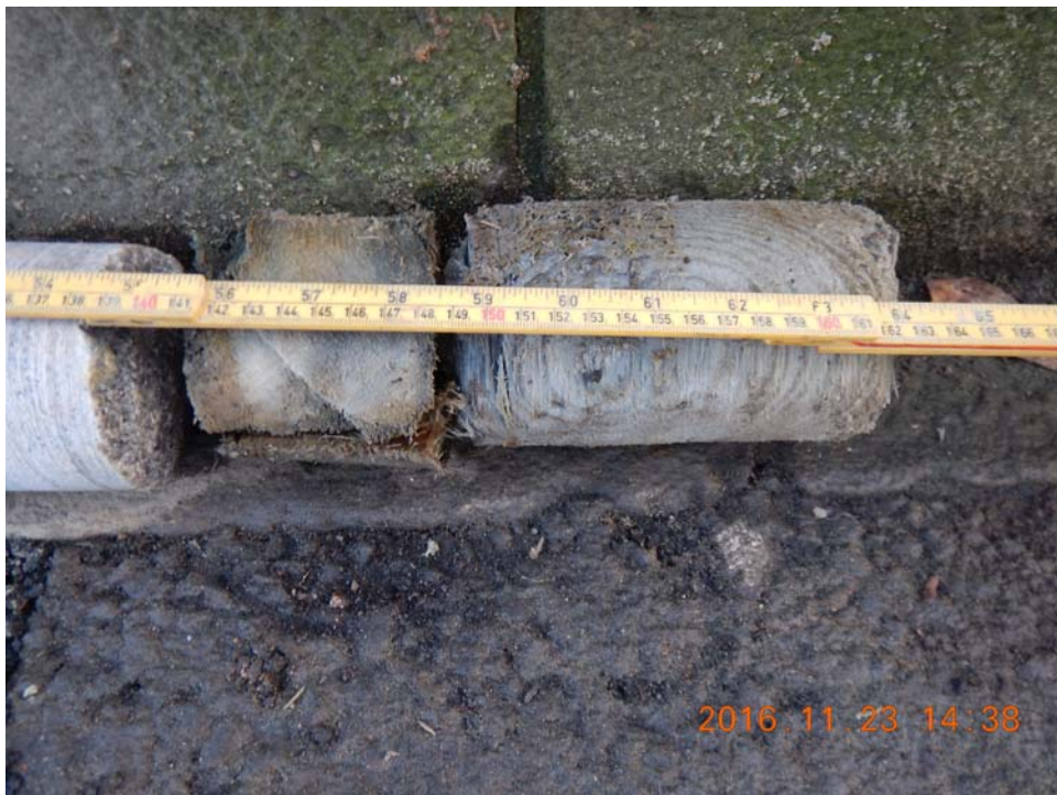
Figur 5. Detalj över borrprov från Vasabrons nordöstra landfäste, samma som ovan. Provet visar rustbädden. Den vänstra övre tätvuxna delen daterades till fällningsår yngre än 1760.
