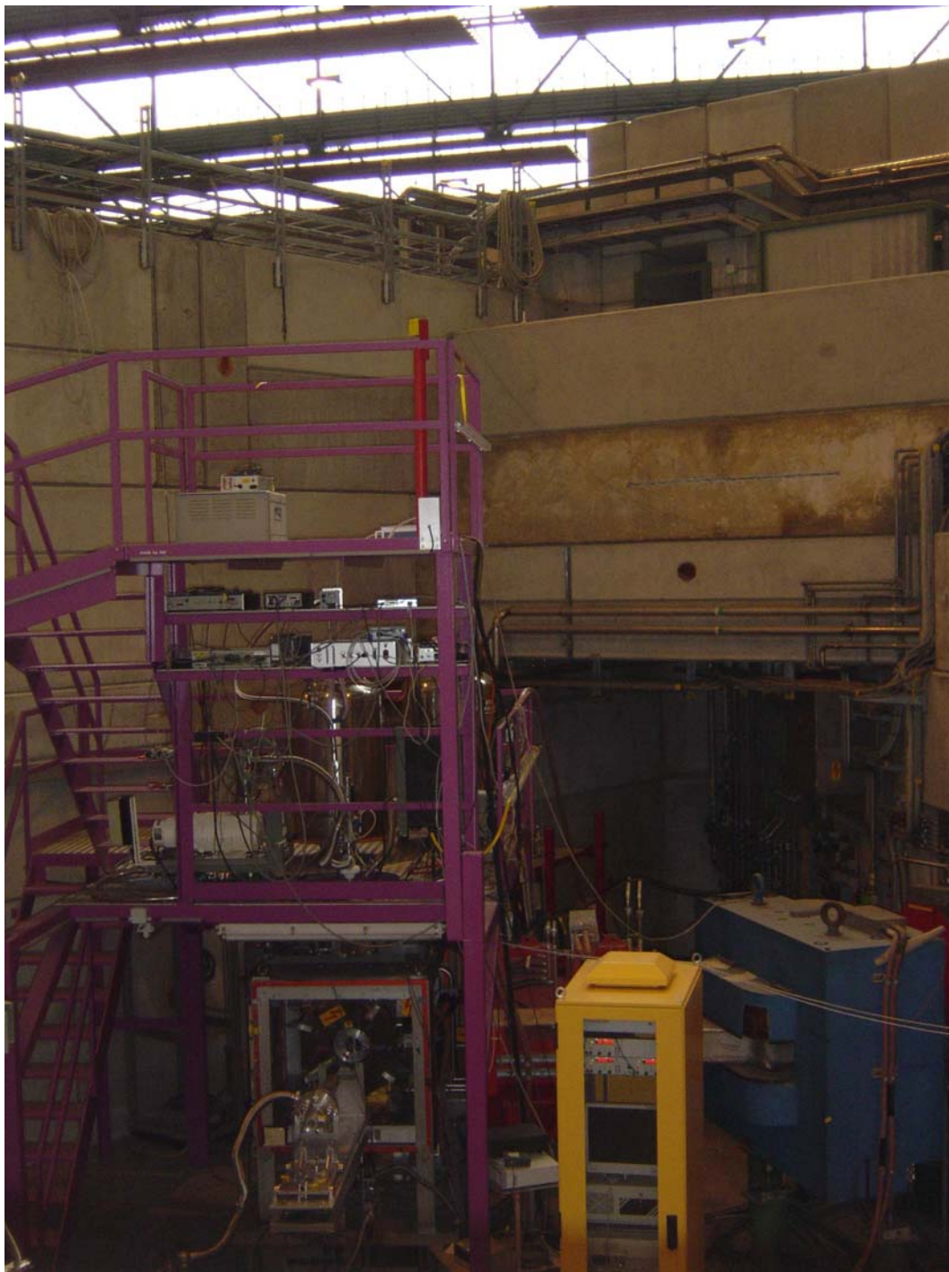
Figura 2.17. Equipo GPD del Paul Scherrer Institute (Suiza) para la realización de experimentos de Rotación-Relajación de Muones.
