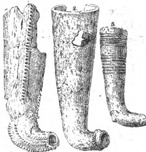
Fig. 65. — Tuyères de fours métallurgiques. — 1, Silésie. — 2 3, Hongrie.
