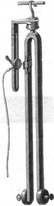
Fig. 72. — Diapason de 10 vibrations doubles disposé pour envoyer ses vibrations à un tambour à levier.
