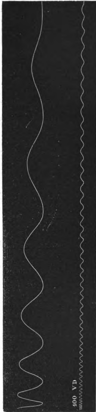
Fig. 119. — Tracé des oscillations de l'aile de l'oiseau artificiel. Au dessous, vibrations du chronographe. On voit de gauche à droite les changements produits par l'accroissement de la vitesse de translation de l'oiseau. (Réduction photographique.)
