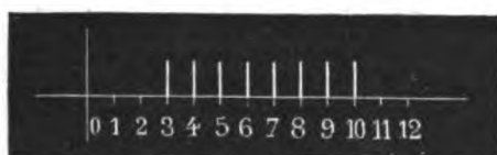
Fig. 3. — Destinée à expliquer la manière dont on mesure la durée d'un courant électrique au moyen d'explorations successives.
