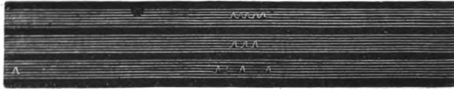
Fig. 36. — Changements de fréquence du flux d'une décharge sous l'influence des changements de la température.
