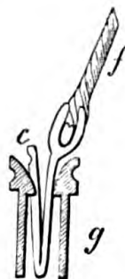
Fig. 158. — g , Gaine métallique. c , Cliquet à ressort. f , fil conducteur.
