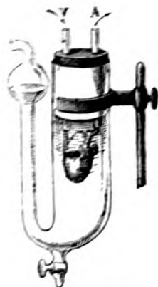
Fig. 95. — Appareil à déplacement pour l'étude des changements de volume du cœur isolé : V, tube d'afflux ; — A, tube d'écoulement artériel.
