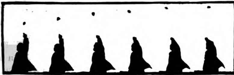
Fig. 15. Une série de silhouettes obtenues à de très courts intervalles, au moyen de l'appareil à six objectifs. L'homme qui lance une pierre présente des attitudes différentes du bras, et la pierre elle-même se déplace d'une image à l'autre. (La partie inférieure du corps était cachée par une balustrade; on l'a supprimée dans la figure.)
