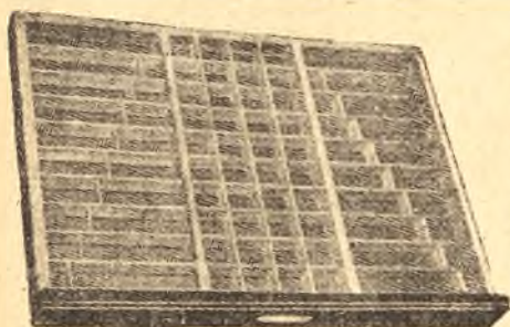
Fig. 15. Casă de linii.
